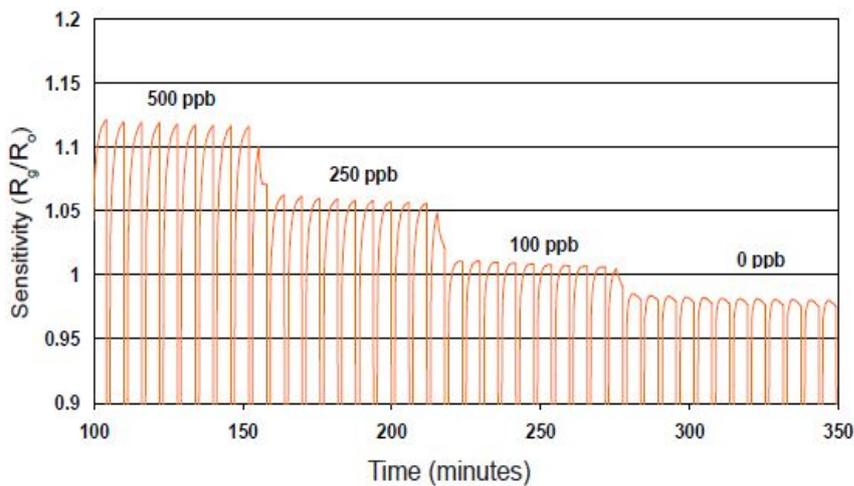
左图为50%RH时传感器在500ppb、250ppb和100ppb时的灵敏度。传感器在两温度模式下工作：400℃持续5min和525℃持续1min（循环脉冲）
