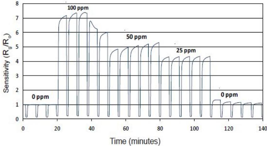
左图为50%RH时传感器在100ppm、50ppm和25ppm时的灵敏度。传感器在两温度模式下工作：400℃持续5min和525℃持续1min（循环脉冲）
