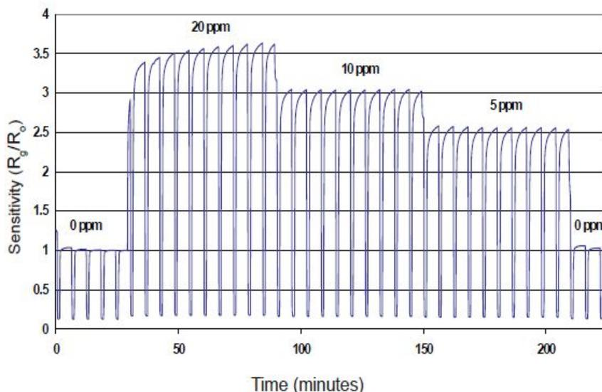
左图为50%RH时传感器在20ppm、10ppm和5ppm时的灵敏度。传感器在两温度模式下工作: 400°C持续5min和525°C持续1min (循环脉冲)
