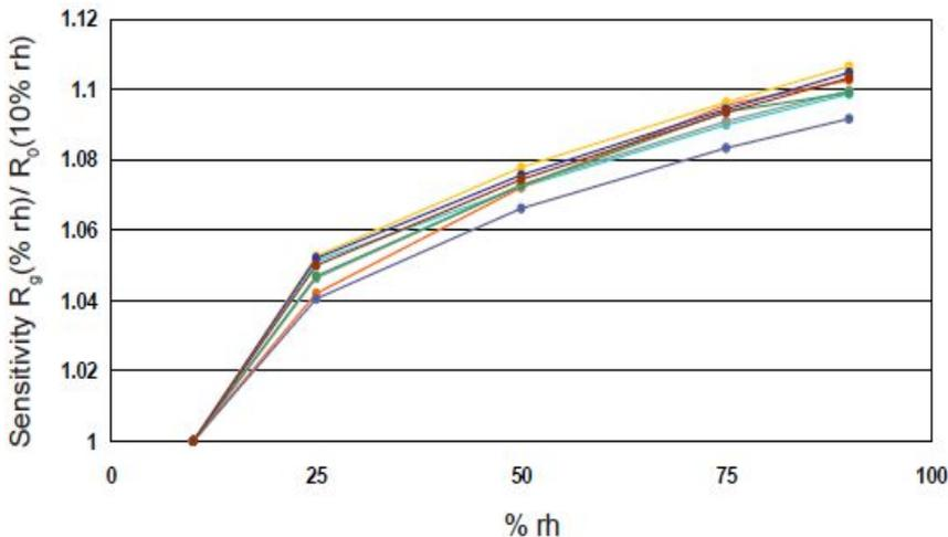
左图 为 10%~90%RH范围内传感器的灵敏度曲线，此时传感器在两温度模式下工作，感应（400℃）和重置（525℃）的循环比为5:1。
